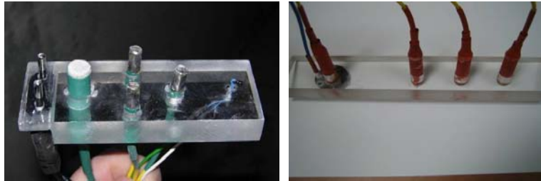
Figura 2. Sensores de corrosión del hormigón
