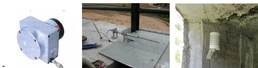
Figura 1. Transductor de desplazamiento potenciométrico \pm 250\text{mm} ; b) transductor de desplazamiento potenciométrico \pm 50\text{mm} . A la derecha la estación meteorológica.
